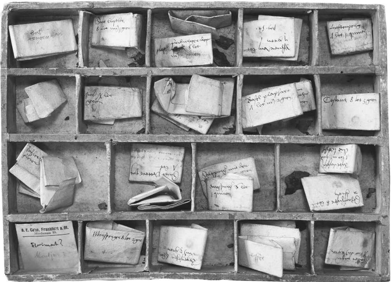
Abb. 4: Probierkasten von Colmar und Probebeispiel eines Batzens 1515 von Schaffhausen mit Schmelzgut, schriftlich festgehaltenem Ergebnis und Rest der beschnittenen Münze 14 .
