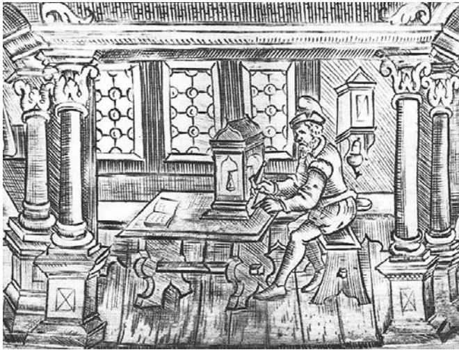
Abb. 2, 3: Ein Schmelzer/Probierer und sein Gehilfe bei der Feuerprobe und der Wardein beim Wägen und Aufzeichnen ins Buch
