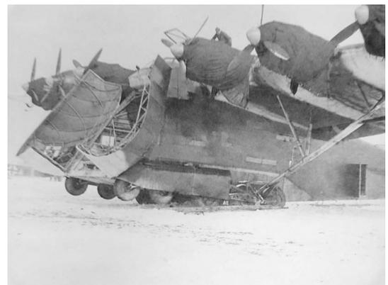
*Eine Me 323 wartet mit geöffneten Ladeluken auf die Beladung. Auffällig ist, dass ein Teil der Fahrwerksverkleidung fehlt. Dies ist auch ein Indiz für den sehr großen Materialverschleiß der Flugzeuge. Die Triebwerke sind gegen Witterungseinflüsse mit Planen abgedeckt.*
