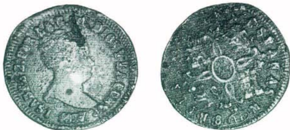
Bild 5.5. Spanien, 8 Maravedi, 1837; Guß aus Glockenmetall (stark porös)
