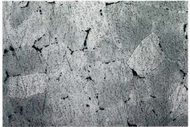
Bild 4.8. Manilla von Westafrika; a) Manilla, 18. Jh.; 70 mm Durchmesser, 102 g, Härte 70 HV5, elektrische Leitfähigkeit 23 S m/mm 2 , b) Mikrogefüge der Manilla, Vergrößerung 50: 1, geätzt
